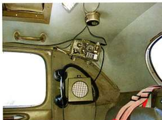
De aanpassingseenheid voor de RA200 antenne, RA200 aerial unit, de RA200 box en een handmicrofoon.
